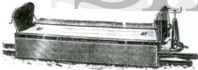
Fig. 122. Le même wagon avec le pareil de décroire-à-baisser horizontalement, celle de devant entièrement rabattue
