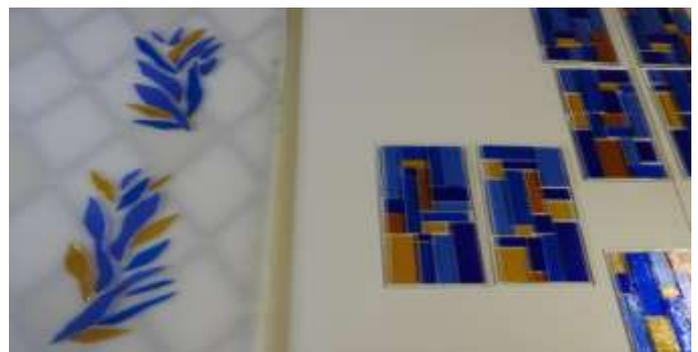
**Il y a deux couches superposées de pièces décoratives sur le verre de support dans l'élaboration du vitrail derrière l'autel du transept.**
