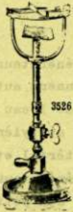
Appareil de laboratoire système J.V.L. avec support de capsule et robinet de réglage.
