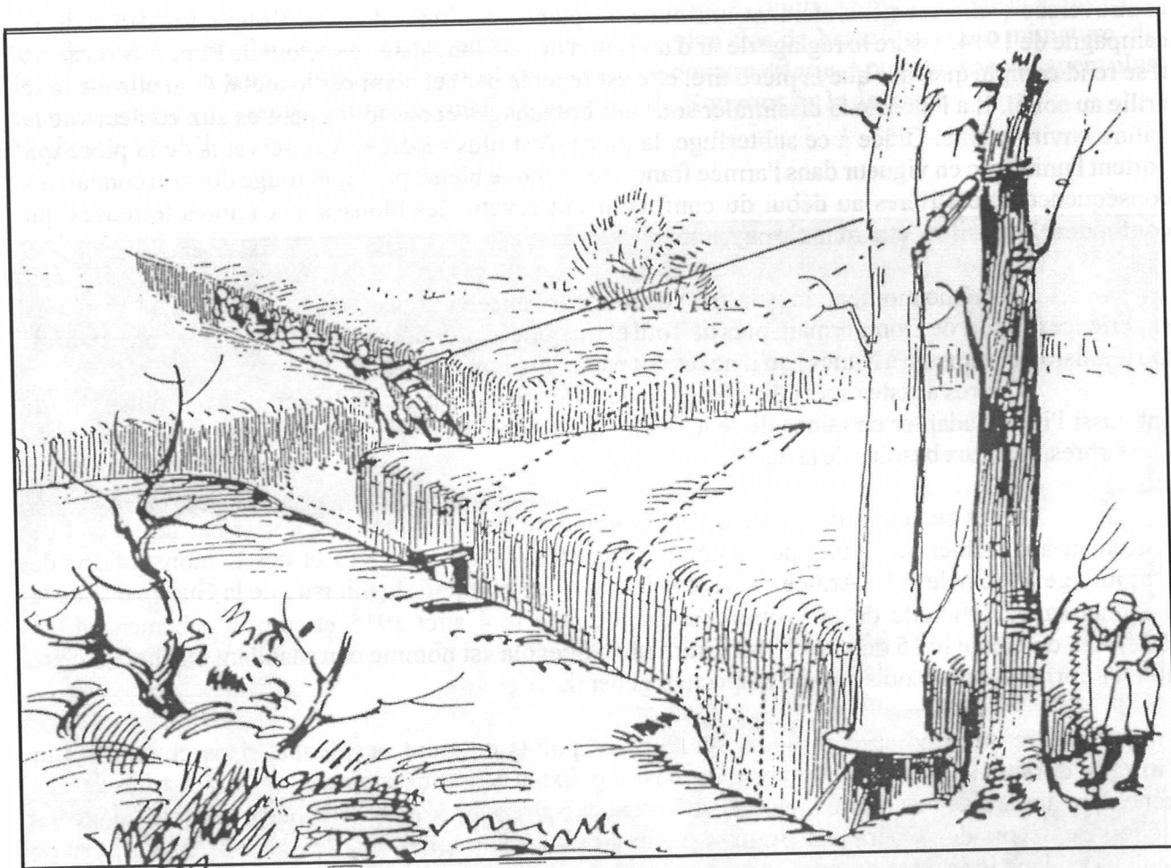
Henri BOUCHARD, carnet n° 56, p. 3. Croquis montrant la mise en place d'un faux arbre. Le faux arbre couché, dans le boyau, est redressé à l'aide de poulies contre le vrai au pied duquel le scieur attend le moment de le faire disparaître. (atelier-musée Henri Bouchard, Paris).
